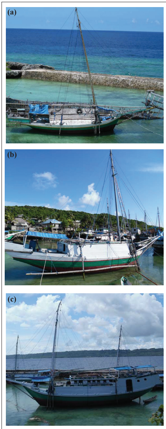
Gambar 1. (a) Perahu desain atap segitiga, (b) Perahu desain atap trapesium, (c) Perahu desain atap persegi panjang penuh
